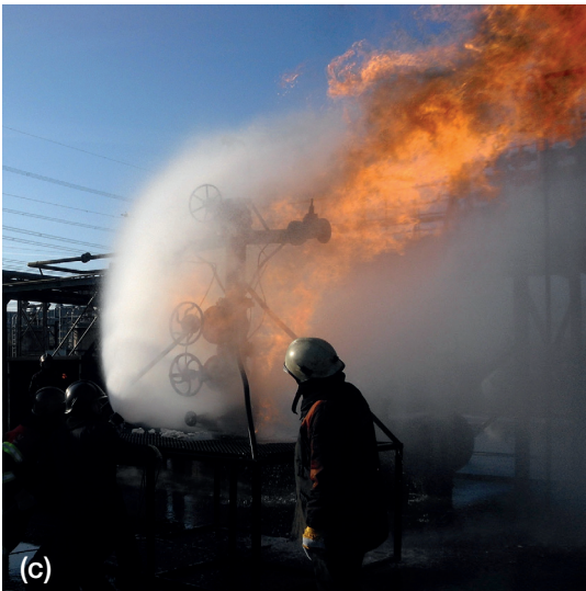
Abb. 19: Einblasen von Wasser in Gasflamme; (a) Gasflamme unter Druck austretend, (b) Annäherung, (c) unter Kontrolle
