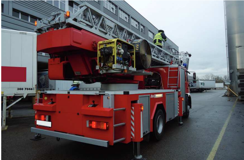
Abb. 52: Fahrzeugführer steigt nach erfolgter Abstützung des Fahrzeuges über die seitliche Aufstiegsleiter in den Leitersatz und von dort aus in den Rettungskorb. Anschließend kann er zügig die Rettungsöffnung ansteuern.
