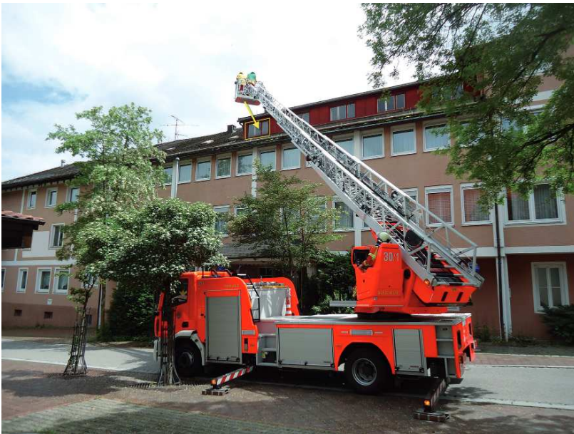
Abb. 54: Anfahren der Rettungsöffnung (gelbe Markierung) von seitlich oben. Hierdurch entsteht maximale Sicherheit für die Korbbesatzung.
