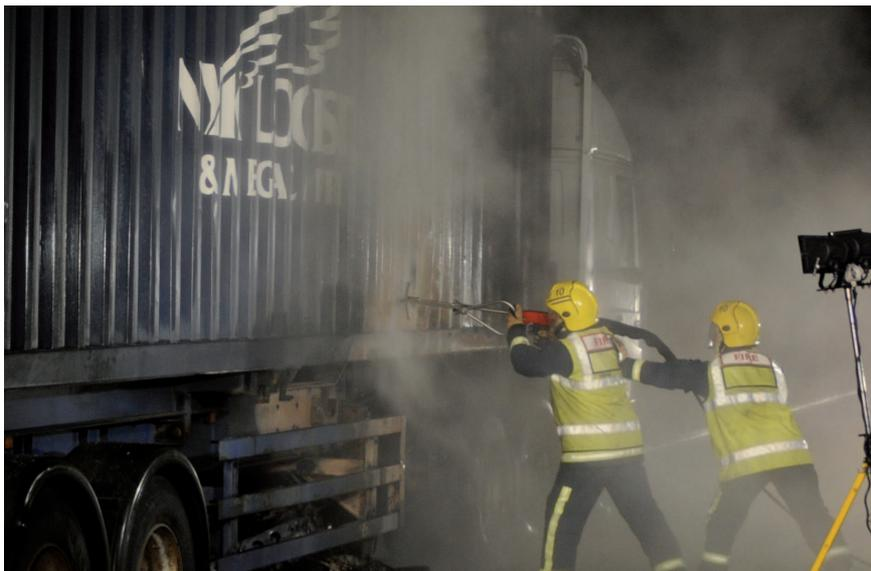
**Abb. 4.3.2/1:** Einsatz des COBRA-Löschsystems bei einem Transportcontainerbrand (Foto: Northamptonshire Fire and Rescue Service, UK)
