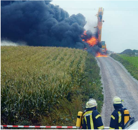
Abbildung 7: „Kran- ausleger berührt Hochspannungsleitung – Fahrzeug brennt – keine Person mehr im/am Fahrzeug – Feuerwehr wartet auf die Freischaltung der Hochspannungsleitung!“ (Quelle: Marc Köppelmann, Paderborn)
