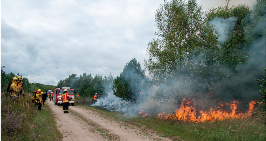
Abb. 33: TSF-W im Pump&Roll-Einsatz (hier bei einer Ausbildung zur Vegetationsbrandbekämpfung). (Foto: Maushake, Vecheide)
