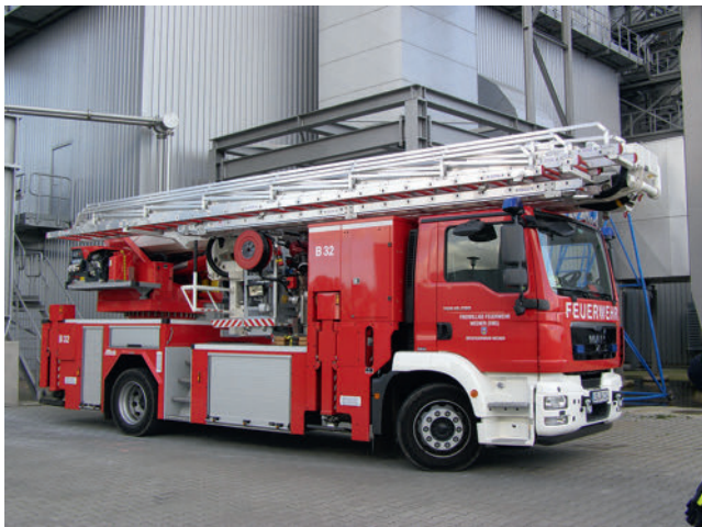
Bild 2: HAB mit Notabstiegsleiter (Fa. Metz/Rosenbauer)
