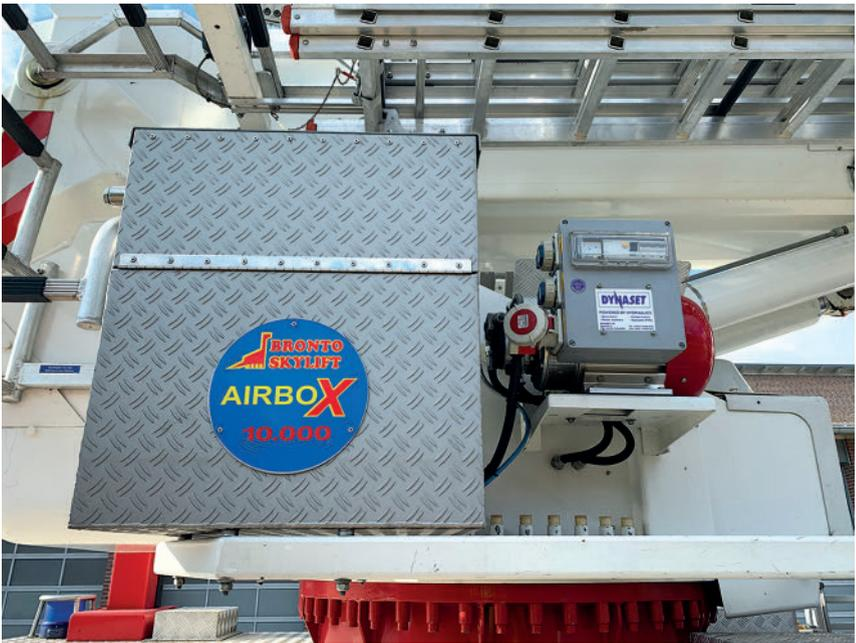
**Bild 2:** Zentrale Atemluftversorgung am Drehgestell einer Hubarbeitsbühne (Quelle: Niels Walle)
