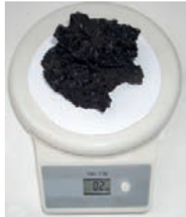
Bild 3b: Waage mit verbranntem Glanzruß (2 Gramm)
