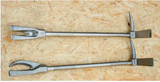
Bild 1: Halligan-Tool mit Hebelklaue (oben) und Halligan-Tool mit Metallschneidklaue (unten) (Foto: Irakli West)
