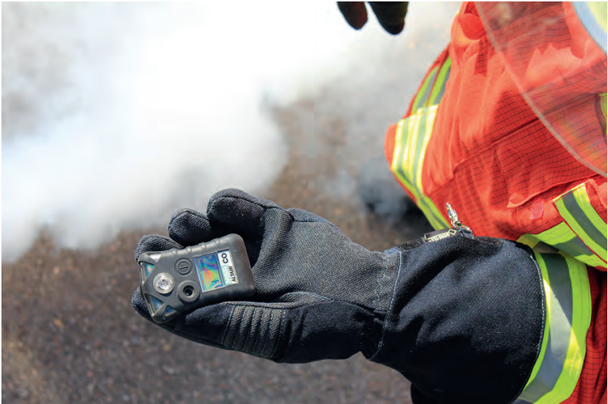
Bild 1: Ein CO-Warner sollte zumindest von den Führungskräften immer dort getragen werden, wo die Gefahr einer CO-Exposition besteht.
