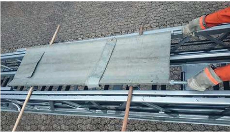
Bild 1 Improvisierte Rettung mit einer Drehleiter, wie sie früher teilweise durchgeführt wurde. Aufgrund der großen Verletzungsgefahr sollte hiervon unbedingt Abstand genommen werden!
