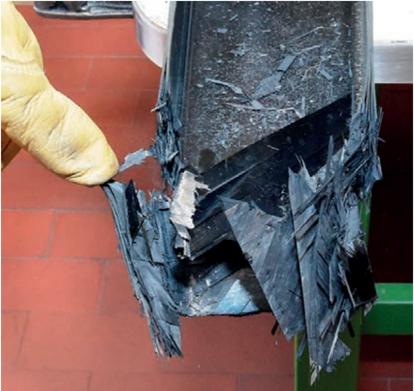
Bild 4: Zerstörtes Bauteil aus Kohlenstofffaserverbundwerkstoff mit Splintern, scharfen Bruchkanten und Faserpartikel (Foto: Branddirektion München)
