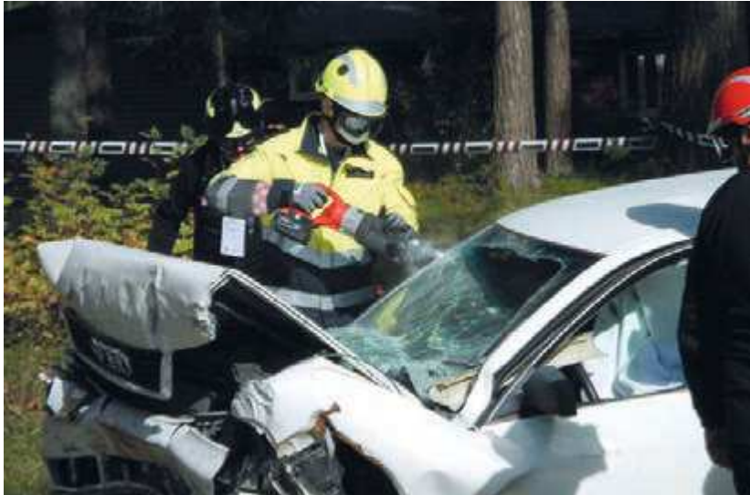
Bild 5 Trennen der Frontscheibe vom Fahrzeugdach mittels Säbelsäge
