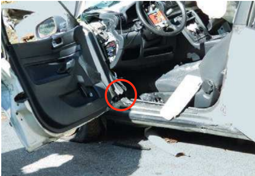
Bild 11 An den Übergängen von der A-Säule zum Schweller werden Entlastungsschnitte gesetzt.
