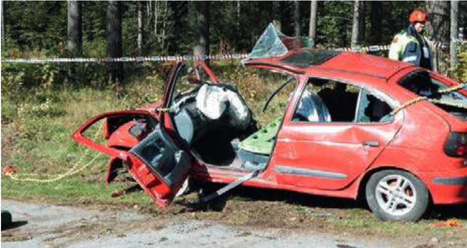
Bild 15 Befreiungsöffnung nach erfolgter Rettung
