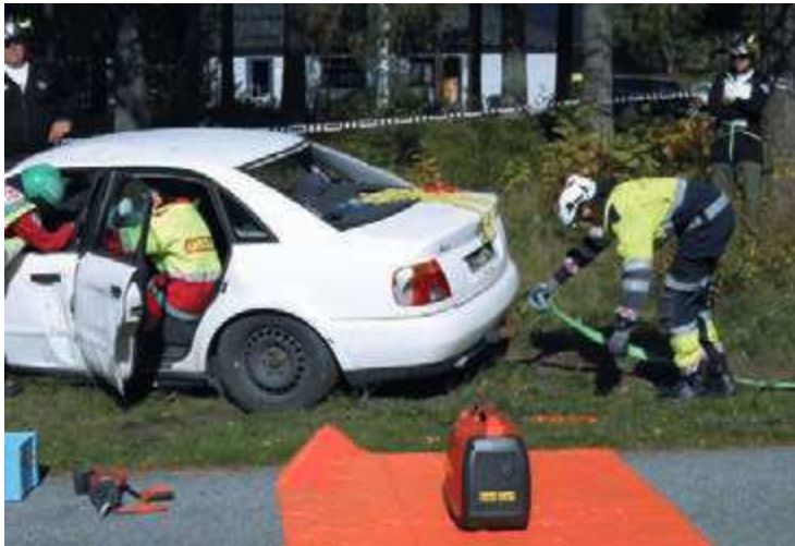
Bild 2 Hier wird das Unfallfahrzeug an der Anhängerkupplung angeschlagen, um es in eine für die Rettung geeignete Position zu ziehen. Die gelben Ketten liegen nur zur Vorbereitung auf dem Kofferraum. Ein Retter verbleibt im Fahrzeug.
