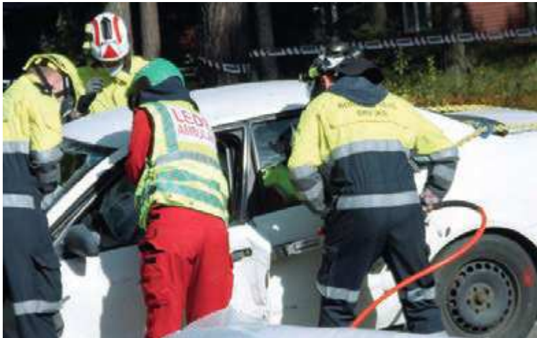
Bild 4 Hier werden die Türen mittels hydraulischem Spreizer geöffnet.
