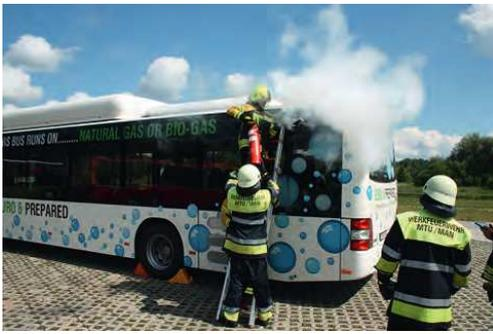
Bild 1: Einblasen von Kohlendioxid in die Luftansaugung
