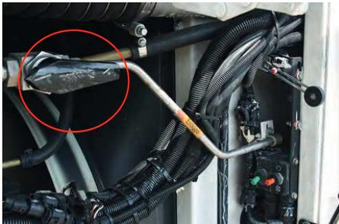
Bild 2: Service-/Notfalltrennschalter und Absperrhahn im Motorraum
