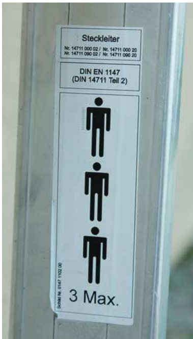
Bild 6: Kennzeichnung einer Steckleiter nach DIN EN 1147 (Nach Norm muss die Steckleiter in jeder Längenkonfiguration mit zwei Personen belastbar sein, hier gibt der Hersteller maximal drei Personen an.)
